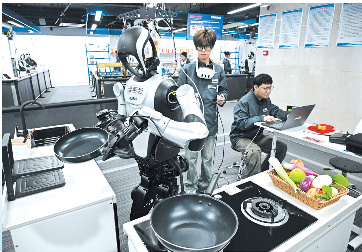
3月23日，在青岛市人形机器人数据采集训练场，数据采集员手持感应手柄操控机器人完成抓取动作。
