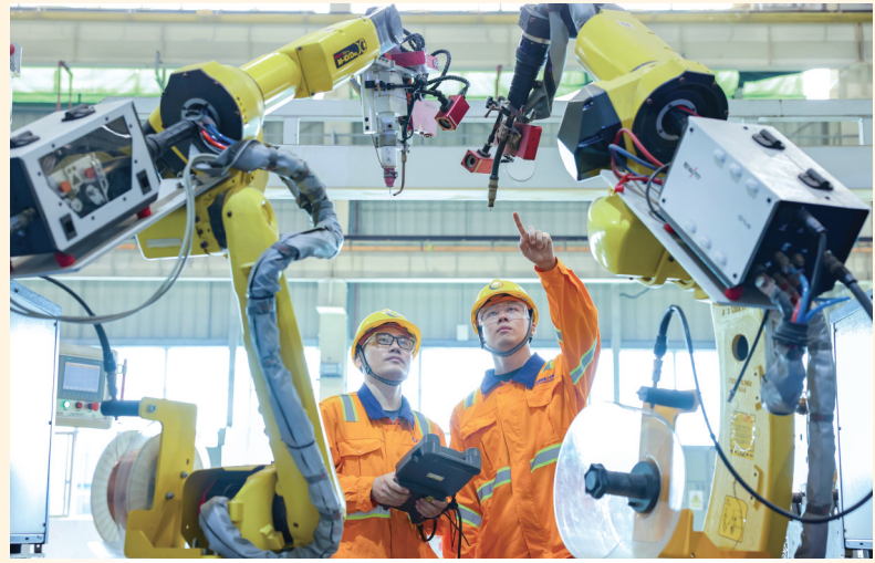
海洋石油工程股份有限公司5月10日发布消息，我国首条深水油气装备工艺管线智能生产线在海南工程珠深海水装备制造基地建设完成，进入调试阶段。图为5月10日，技术人员在调试深水油气装备工艺管线智能生产线的焊接机械臂。 新华社发(刘聪 摄)
